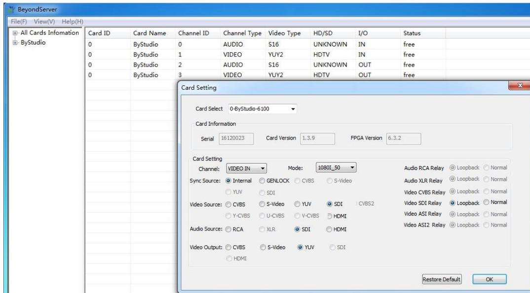
2) 先在“Card Select”列选择板卡，然后在“channel”列，设置采集视频信号，确保和实际接入的信号源保持一致；如：采集为 1080I50 的高清信号，则选择 Video In（采集视频），在右边“Model”列，设置视频分辨率为 1080I\_50，选择视频源（video Source），音频源（Audio Source）为 SDI。
